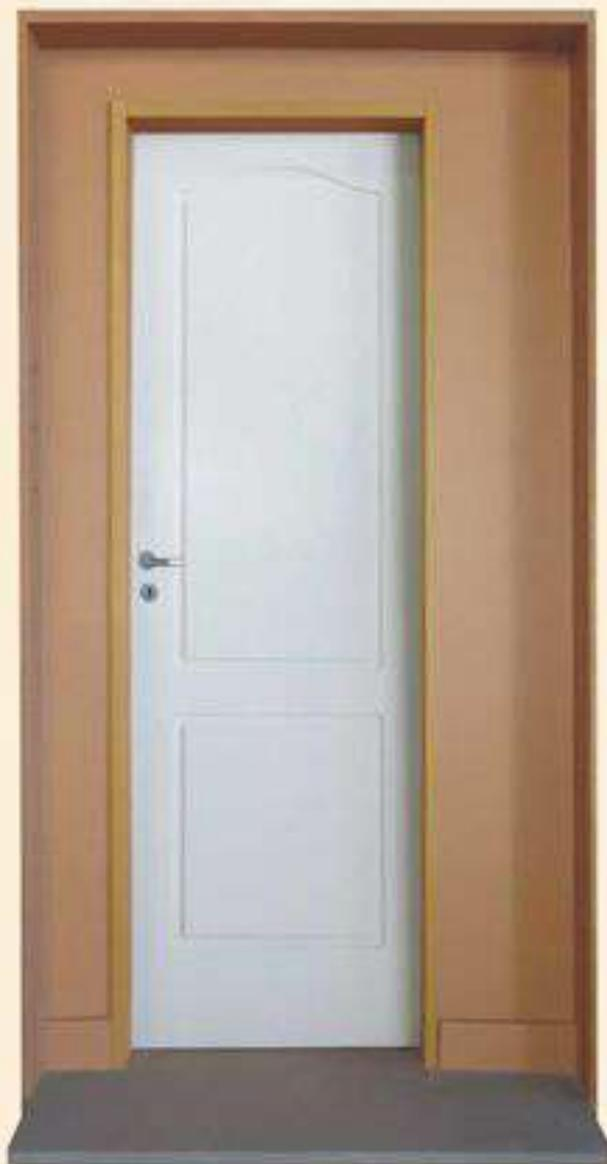
**Hoja:** Fabricada en MDF de 5 mm. pantografiado en ambas caras. Cantos laterales enchapados. Doble contacto. **Con fondo blanco para madera.**
